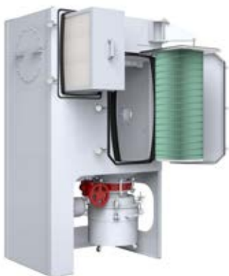
QPP1 PX1 1 cartouche Débit d'air : 500 - 1200 m 3 /h Ventilateur intégré Dépression de -5kPa
